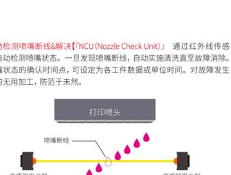
**自动检测喷嘴断线&解决【NCU (Nozzle Check Unit)】** 通过红外线传感器自动检测喷嘴断线。一旦发现喷嘴断线，自动实施清洗直至故障消除。喷嘴状态的确认时间点，可设定为各工件数据或单位时间。对故障发生后的无用加工，防范于未然。
